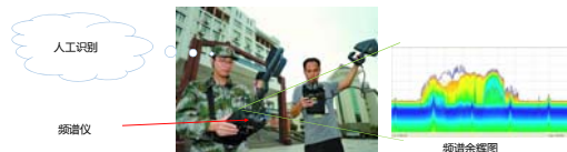
图1 早期无线电信号识别: 利用仪器将频谱可视化, 然后由人工判别。
