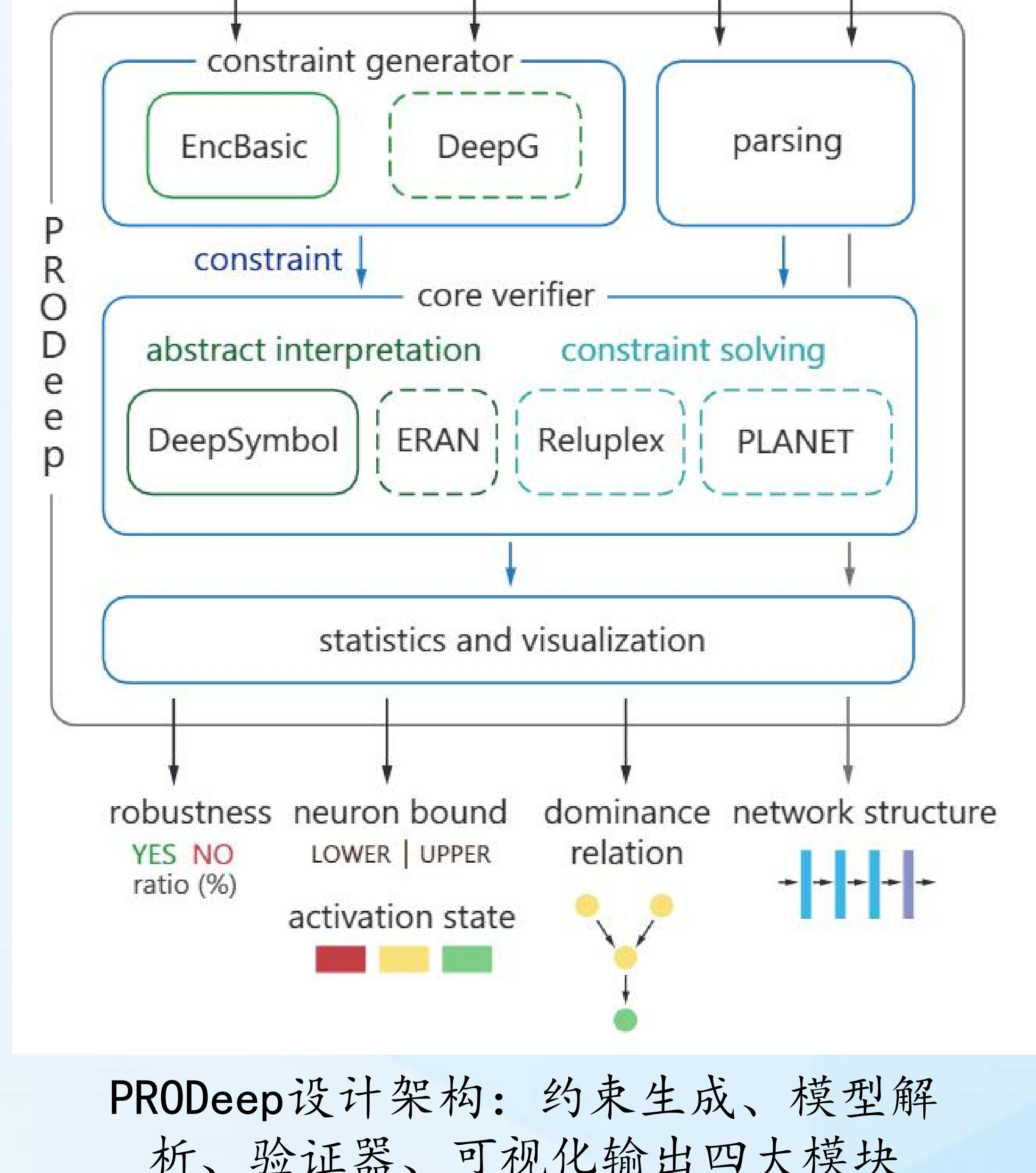
PRODeep 设计架构：约束生成、模型解析、验证器、可视化输出四大模块
