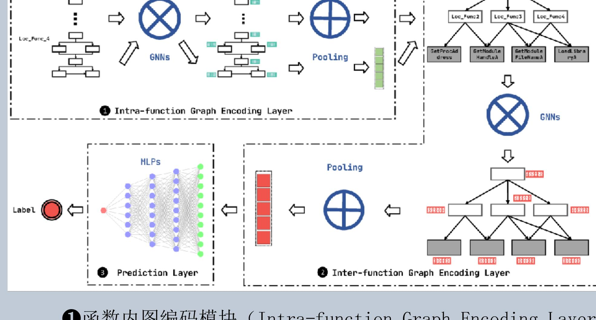
①**函数内图编码模块 (Intra-function Graph Encoding Layer):** 利用图神经网络和池化网络来学习一个可执行软件中每个本地函数对应的控制流图的全局图向量;
